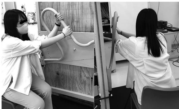
写真1 試作品のトイレ用ラ・クリップの両手で手すりを把持する場合の基本的な使用法
